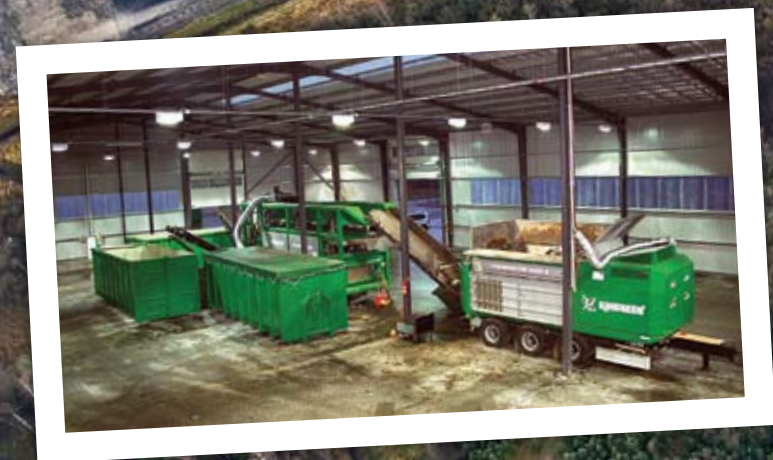
ATKRITUMU PRIEKŠAPSTRĀDES CENTRS. Nesen pabeigtajā angārā uzstādītas atkritumu priekšapstrādes iekārtas, kas veic atkritumu mehānisko apstrādi – šķirošanu un smalcināšanu. Patlaban iekārtas strādā testa režīmā, bet no nākamā gada darbosies ar pilnu jaudu
