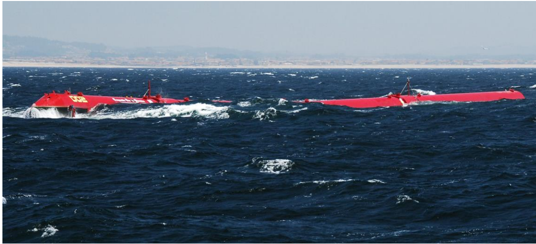
10.att. Viļņu enerģijas konvertors PELAMIS, Portugālē.
