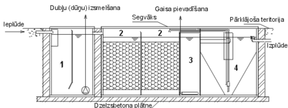
45. attēls. AS-ANAcomb tipa attīrīšanas iekārtas tehnoloģiskā shēma
