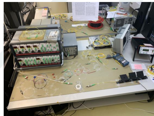
RTU TI ŠOPS laboratorijā izveidotā riņķveida rezonatora slēguma shēma.
